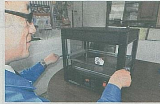
簡単に短時間で立体物の型を取ることができる3D造形機「マイクロフォーマーR001」 東京都葛飾区
