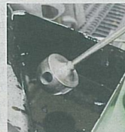
エディプラスが手がける羽根のない攪拌機。塗料を攪拌する際、ごみを出さない工夫から生まれた
