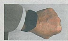
視覚障害者向けに振動で時刻を 伝える腕時計型「Tac-Touch （タックタッチ）」
